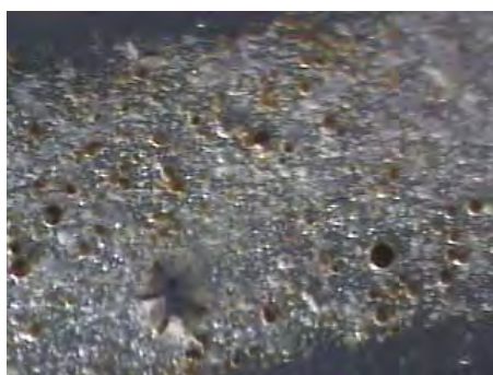
Figure 2 : micrographie d'un fil blanc opaque et diagramme de composition rapport plomb antimoine
