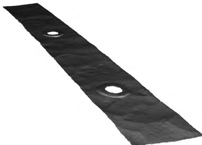
Figure 2 : Un exemple de modélisation en 3D réalisée par l'unité de géomatique de l'Université de Liège sur une face d'un étrier de la cathédrale Saint-Paul (Liège) daté de 1290-1300 qui permet de mettre clairement en évidence les pas du marteau probable hydraulique (échantillon LPAU.01).
