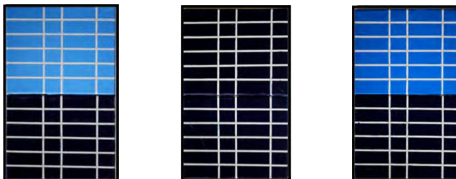
Figure 1 : Eprouvettes : couleurs à l'huile à base de PB15:0 (a), PB15:1(b), PB15:3 (c) appliquées sur un support toile
