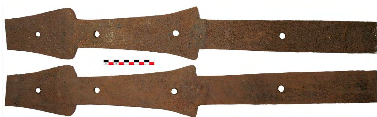
Figure 1 : Exemple d'un fragment important d'étrier prélevé dans la cathédrale Saint-Paul (Liège) et daté de 1328-1330 (échantillon LPAU.03).
