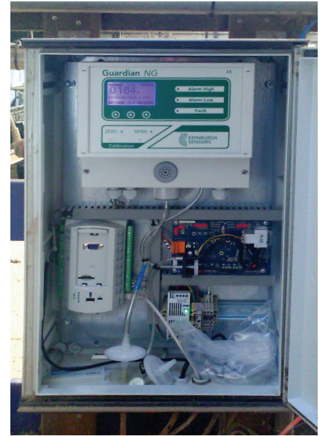
Guardian NG Messgerät aus dem Versuchstall der Uni Arrhus im dänischen Foulum. Lediglich ein kleiner Luftschlauch aus Kraftfutterbox oder Melkroboter erlaubt es Methan (%) in der Luft zu bestimmen.
